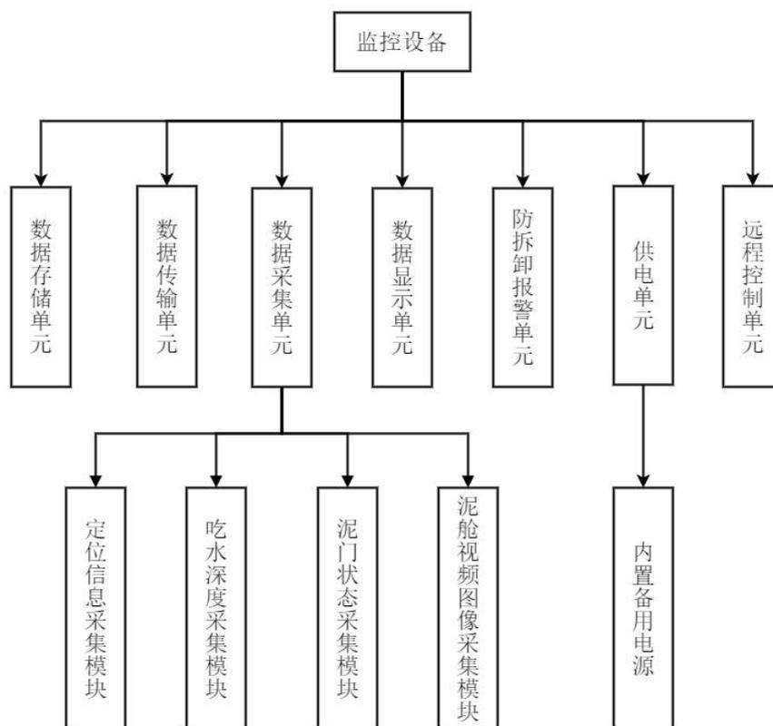
图1 监控设备功能单元组成示意图
